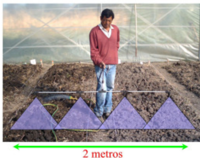
Foto 1: Barra portapicos de pulverización de 2 metros de ancho.
